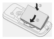
Per togliere la batteria premere sulla linguetta sul lato della batteria ed estrarla.  Collocare il coperchio della batteria leggermente scentrato (4) quindi farlo scivolare fino a bloccarlo in posizione.
