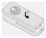
Per rimuovere la batteria, spingere la chiusura verso l'interno con l'unghia ⑤ e far scivolare il coperchio verso l'alto ⑥.
