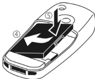
Per togliere la batteria premere sulla linguetta sul lato della batteria ed estrarla.
