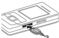
À l'achat, la batterie neuve n'est pas complètement chargée. Brancher le câble du chargeur sur le côté du
