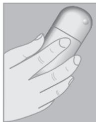
Das Telefon oberhalb des Akkudeckels nicht unnötig abdecken. Die Empfangsqualität würde gemindert werden (integrierte Antenne).
