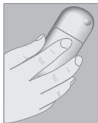
Não cobrir sem necessidade de o telefone acima da tampa da bateria. A qualidade de recepção seria diminuída (antena integrada).
