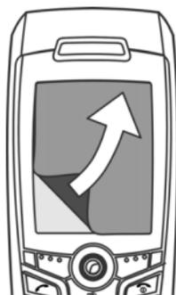
En el estado de suministro, el display está cubierto con una **lámina protectora**. Retire con cuidado estas láminas antes del montaje.
