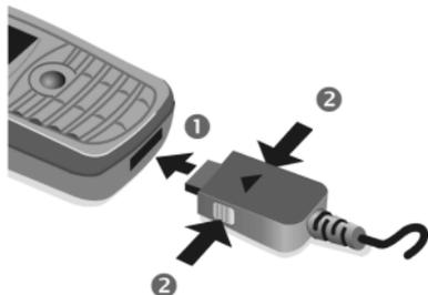
Zum Abziehen die seitlichen Tasten auf dem Stecker in Pfeilrichtung zusammendrücken **2**.
