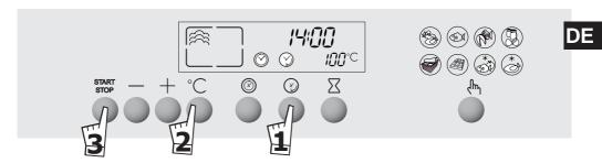
**1** Die Taste "Ende des Garvorgangs" drükken. Die Enduhrzeit des Garvorgangs wird angezeigt und blinkt, desgleichen das Symbol
