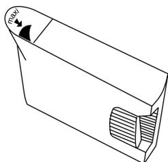
Serbatoio che permette l'alimentazione d'acqua del vostro forno in maniera indipendente. La capienza è di circa 1 litro (livello massimo).
