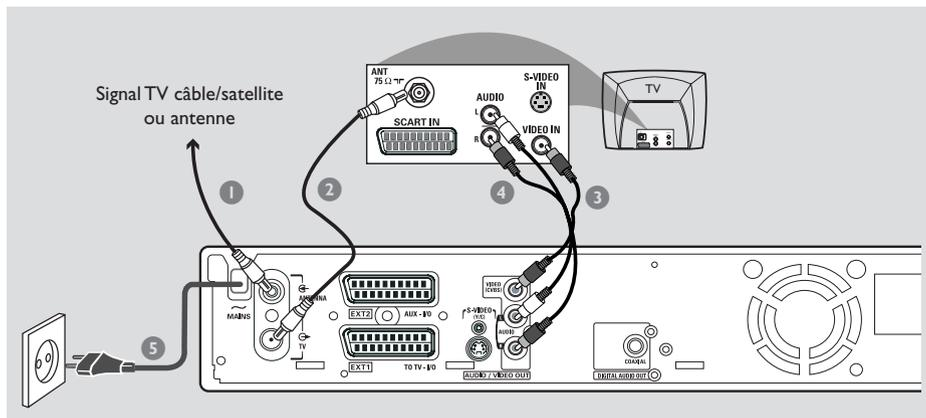
Ce câble cinch, généralement à fiches de couleur jaune, permet de transmettre le signal vidéo composite (FBAS, CVBS). Dans ce type de transmission, le signal de couleur et le signal de luminosité sont transmis via le même câble.
