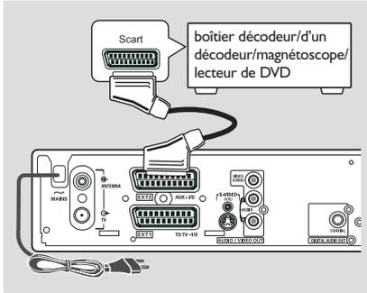
Vous pouvez raccorder un magnétoscope, un lecteur de DVD, un décodeur, un récepteur satellite ou un boîtier décodeur à la prise **EXT 2 AUX-I/O** située à l'arrière du DVD Recorder.
