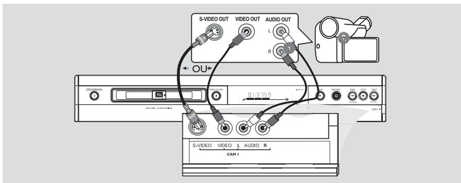
Vous pouvez utiliser les connecteurs de la face avant pour copier les enregistrements de votre caméscope. Ces prises sont situées derrière le volet dans la partie droite de la face avant.
