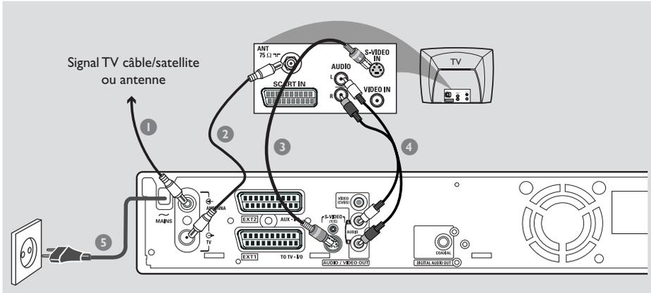
Ce câble de raccordement, également appelé câble S-VHS, sert à transmettre le signal de luminosité (signal Y) et le signal de couleur (signal C) de manière séparée. Cette mini-prise DIN est également appelée prise Hosiden.
