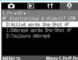
1: Permet d'éviter tout décalage de la mise au point par rotation accidentelle de la bague de mise au point après un autofocus One Shot. Si les deux fonctions C.Fn-07-1 et C.Fn-07-2 sont activées, la mise au point manuelle est possible avec le sélecteur autofocus/manuel réglé sur <MF> ou <M>.
