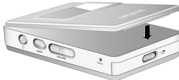
Figura 2-3: Fijación de la cubierta.
