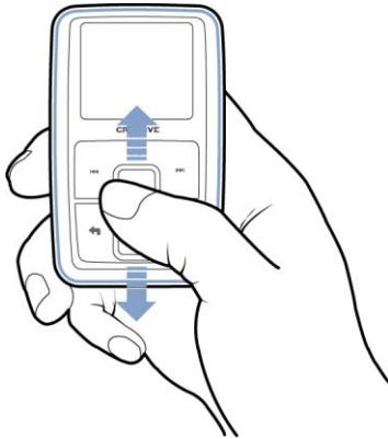
Mueva el dedo pulgar hacia arriba o hacia abajo en el panel de control táctil vertical para desplazarse por los distintos elementos del menú.
