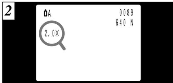
Si pulsa la flecha "▲" cuando está fotografiando, será ampliada la imagen y en el monitor LCD aparecerá "2.0×". Pulse la flecha "▼" para volver a la escala normal.
