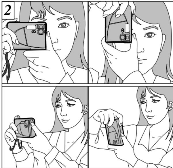
Coloque la correa en torno a su muñeca, presione los codos sobre su cuerpo y sujete la cámara firmemente con ambas manos. Cuando utilice la cámara en posición vertical, sujétela de tal forma que el disparador quede en la parte superior.
