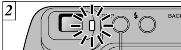
Al conectar la cámara, la lámpara del visor cambia al color verde. Para desconectar la cámara, sitúe el conmutador de modos en la posición “OFF”.
