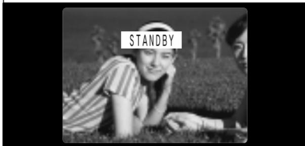
Pulse el disparador hasta la mitad de su recorrido (bloqueo AF/AE) y compruebe si aparece “STANDBY” en el monitor LCD (o si la lámpara verde del visor deja de parpadear y permanece encendida).
