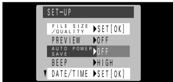
Una vez activada esta función, el monitor será desconectado temporalmente para reducir el consumo de energía (modo descanso) si la cámara no es utilizada durante unos 15 segundos. Si la cámara deja de utilizarse durante un tiempo adicional más prolongado (2 ó 5 minutos), será desconectada automáticamente. Utilice esta función cuando desee conseguir la máxima duración posible de la carga de las pilas.
