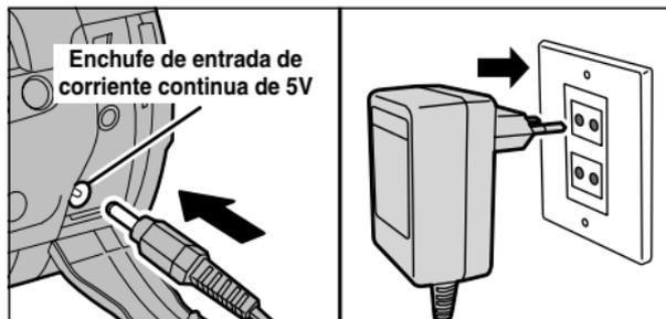
Compruebe que la cámara se encuentra desconectada. Abra la tapa del terminal e introduzca la clavija del cable del transformador de corriente alterna en el enchufe "DC IN 5V". A continuación enchufe el transformador de corriente alterna en el enchufe de la red.
