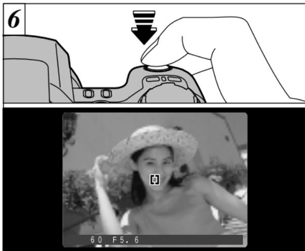
Cuando se pulsa el disparador hasta la mitad de su recorrido, el tamaño del recuadro AF de la pantalla se reduce y la cámara queda enfocada. La cámara selecciona también en ese momento los ajustes de la velocidad de obturación y de la apertura de diafragma.
