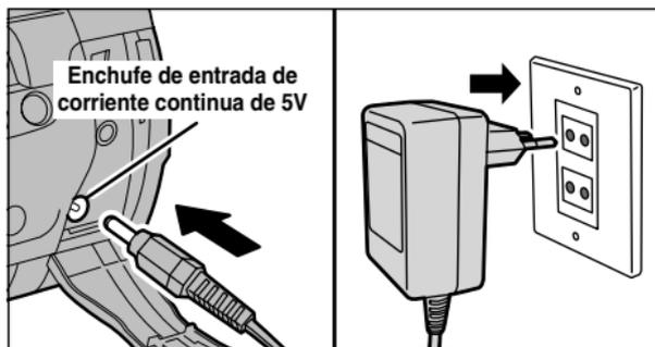
Si existiera un enchufe a la red en las proximidades, debería de utilizar el transformador de corriente alterna AC-5V/AC-5VH (se vende por separado) para evitar cualquier bajada de tensión durante la reproducción de imágenes estáticas o en movimiento (⇒P.16).
