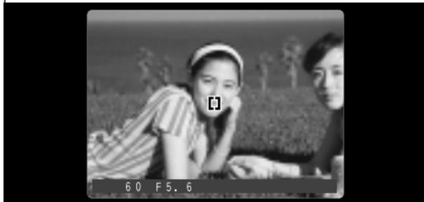
Pulse y mantenga pulsado el disparador hasta la mitad de su recorrido (bloqueo AF/AE). Se reduce el tamaño del recuadro AF que aparece en la pantalla y la cámara determina el ajuste de la velocidad de obturación y la apertura.
