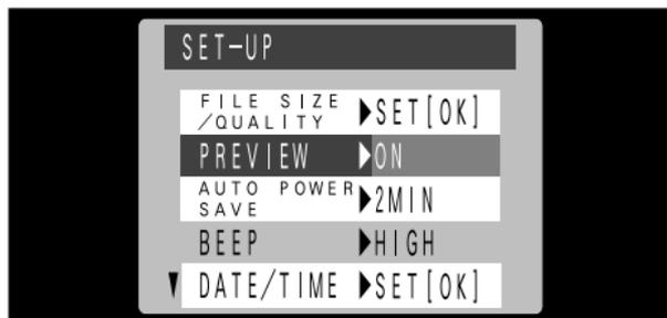
Utilice este ajuste para especificar si una pantalla previsualizada (en la que aparece la imagen fotografiada) ha de ser mostrada después de realizar la fotografía.
