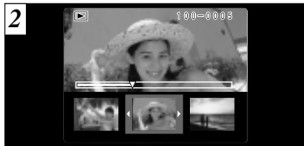
Durante el avance rápido, aparecen a la vez 3 fotogramas en miniatura en el monitor. Al detener el avance rápido, la imagen del fotograma se muestra sola en el monitor.
