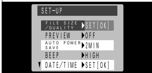
① Ajuste el dial de modos a “” ② y ajuste el dial de modos fotográficos a “**SET**”. Aparecerá en el monitor LCD la pantalla de configuración.
