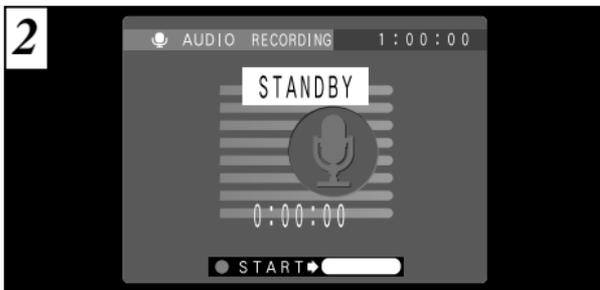
El tiempo de grabación de sonido disponible se muestra en el ángulo superior derecho del monitor LCD, mientras que el tiempo de grabación realizada y el mensaje “STANDBY” se muestran en el centro del monitor LCD.
