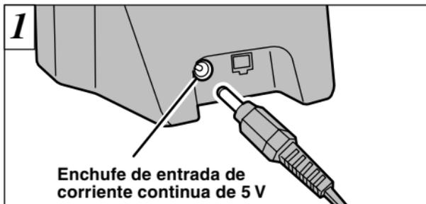
Conecte el transformador de corriente alterna AC-5V/AC-5VH al soporte especial.
