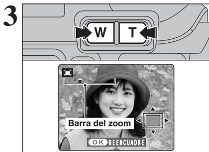
Pulse el botón "T" o "W" durante el modo de reproducción de un solo fotograma para acercar o alejar la imagen por la acción del zoom (ampliación). La barra del zoom aparece en el monitor LCD.
