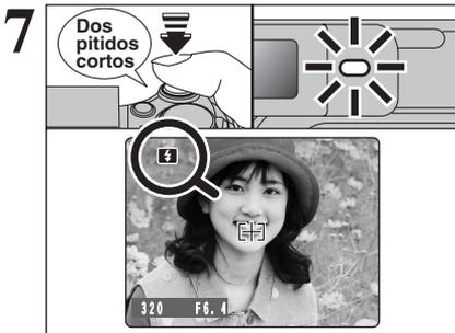
Pulse el disparador hasta la mitad de su recorrido. La cámara emite dos pitidos cortos y enfoca el sujeto. El recuadro AF se hará más pequeño en el monitor LCD y la cámara ajustará la velocidad de obturación y la abertura. La lámpara del visor (verde) pasa de lucir intermitentemente a fijo.
