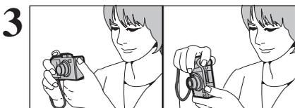
Apoye los codos en los costados y sujete la cámara con ambas manos. Sujete la cámara de forma que el dedo pulgar quede en la posición adecuada para manejar el zoom.
