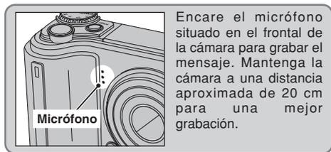
Encare el micrófono situado en el frontal de la cámara para grabar el mensaje. Mantenga la cámara a una distancia aproximada de 20 cm para una mejor grabación.
