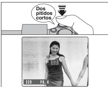
Pulse el disparador hasta la mitad de su recorrido (bloqueo del AF/AE), la cámara emite dos pitidos cortos y enfoca el sujeto. El recuadro AF del monitor LCD reduce su tamaño y la cámara ajusta la velocidad de obturación y la apertura. La lámpara del visor (verde) pasa de lucir intermitentemente a fijo.
