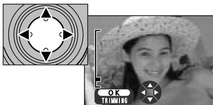
Deslizando el conmutador del zoom durante la reproducción foto a foto y utilizando la acción de ampliación del zoom se amplía la imagen estática. Al hacerlo, aparecerá la barra del zoom en la pantalla.
