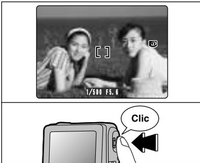
Manteniendo pulsado el autofocus hasta la mitad de su recorrido (bloqueo AF/AE), vuelva a enfocar la cámara sobre la primera imagen y pulse el disparador a fondo.
