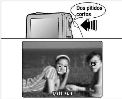
Al pulsar el disparador hasta la mitad de su recorrido, la cámara emitirá un doble pitido de corta duración y quedará enfocado el sujeto. En este momento, el recuadro AF de la pantalla reducirá su tamaño y la cámara ajustará la velocidad de obturación y la abertura. (El indicador luminoso (verde) pasará de lucir intermitentemente a lucir fijo).
