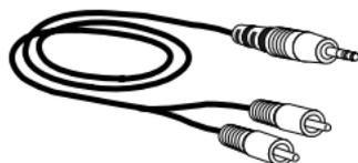
**NOTA** También puede utilizar cualquier cable de audio de adaptador Y con clavijas RCA en un extremo y un enchufe mini-estéreo de 3,175 mm en el otro extremo. También necesitará una clavija de adaptador que acepte un enchufe de 3,175 mm y encaje en un enchufe de 2,38 mm.
