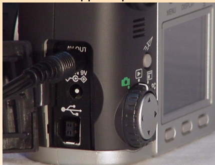
Figure 36 : Branchement du câble vidéo sur l'appareil photo
