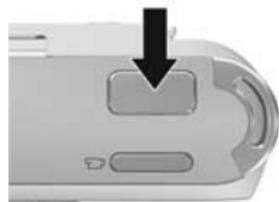
2. Drücken Sie den **Auslöser**, um das Bild aufzunehmen. Nach dem Aufnehmen des Bildes gibt die Kamera ein akustisches Signal aus.
