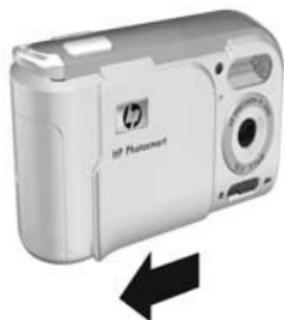
Schieben Sie zum Ausschalten der Kamera den Objektivdeckel wieder über das Objektiv, bis Sie ein Klickgeräusch hören.
