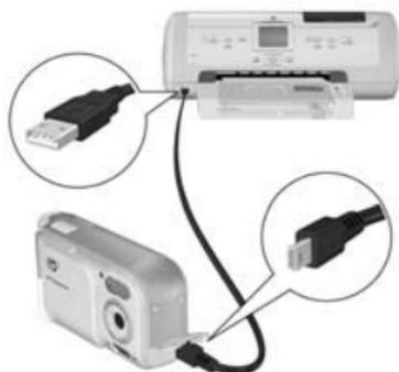
**TIPP:** Der PictBridge Anschluss befindet sich in der Regel an der Vorderseite des Druckers.
