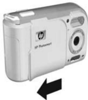
Pour éteindre l'appareil photo, faites glisser le cache de l'objectif jusqu'à ce qu'il s'enclenche, recouvrant ainsi l'objectif.
