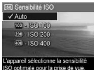
Si le paramètre sélectionné n'est pas le paramètre **Auto** par défaut, l'icône correspondant à ce paramètre (icône utilisée dans le sous-menu **Sensibilité ISO**) apparaît sur l'écran de **prévisualisation**. Le nouveau paramètre reste actif jusqu'à ce que vous le changiez à nouveau ou que vous éteigniez l'appareil photo. Le réglage de la **sensibilité ISO** revient à sa valeur par défaut, **Auto**, lorsque vous éteignez l'appareil photo.
