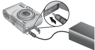
Eine blinkende Kontrollleuchte für den Batterieladezustand an der Kamera zeigt an, dass die Batterie geladen wird (wenn sie in einer optionalen HP Photosmart Premium-Dockingstation oder einer kabellosen Dockingstation geladen wird, blinkt die Kontrollleuchte der Dockingstation). Die Batterie ist vollständig aufgeladen, wenn die Kontrollleuchte für den Batterieladezustand durchgängig leuchtet (nach ca. 12–15 Stunden).
