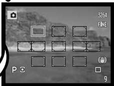
Mit den oberen/unteren und linken/rechten Steuertasten können Sie das Spot-AF-Messfeld oder den flexiblen Fokuspunkt auswählen. Drücken Sie die mittlere Steuertaste oder halten Sie den Auslöser leicht gedrückt, um das AF-Messfeld zu speichern. Das gewählte Messfeld wird weiß eingefärbt dargestellt. Beachten Sie die Angaben auf den folgenden Seiten.
