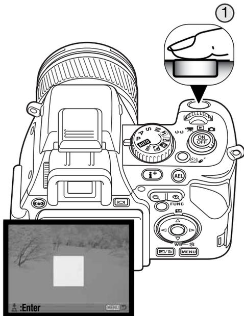
Der Messbereich wird auf dem Monitor angezeigt. Wählen Sie eine weiße (oder besser eine neutralgraue) Fläche auf die Sie den Messbereich zentral ausrichten. Die Fläche muss den Messbereich ganz ausfüllen.
