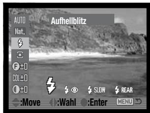
Die aktive Blitzfunktion wird im EVF-Sucher und auf dem Monitor durch einen Indikator angezeigt, wenn das Blitzgerät aufgeklappt wurde.
