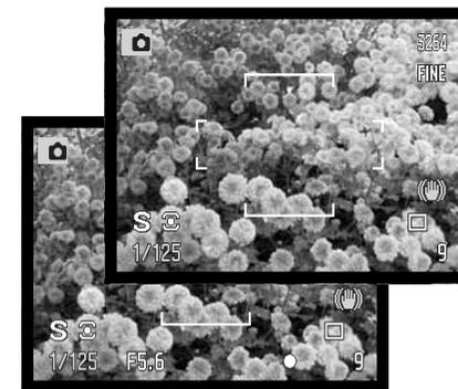
Bei Verwendung eines Blitzgerätes sollten Sie die Verschlusszeit an die Blitzdauer anpassen, um eine Unterbelichtung zu vermeiden. Es wird empfohlen, die Verschlusszeit von 1/1000s nicht zu unterschreiten, wenn Sie das eingebaute Blitzgerät verwenden bzw. die Verschlusszeit von 1/250s mit einem kompatiblen externen Konica Minolta Blitzgerät.
