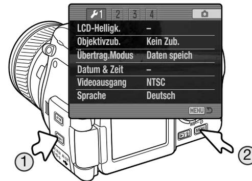
Halten Sie die Funktionstaste gedrückt (1) und drücken Sie die Menütaste (2), um das Setup-Menü zu öffnen.
