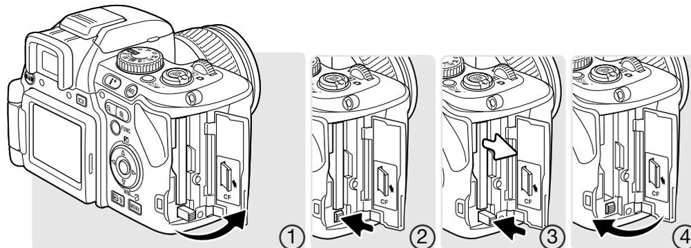
Um eine Karte auszugeben, öffnen Sie die Kartenschachtklappe (1) und drücken Sie den Kartenentnahmehebel (2), der sich daraufhin anhebt.
