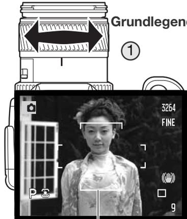
Stellen Sie mit dem Brennweitenring den gewünschten Bildausschnitt ein (1). Die Brennweitenänderung wird zeitgleich im EVF-Sucher und auf dem LCD-Monitor angezeigt.
