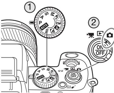
Drehen Sie das Belichtungsmodusrad (1) auf die Position „P“ (Programmautomatik). Achten Sie darauf, dass der Modusschalter (2) auf der Position „Aufnahme“ steht.
