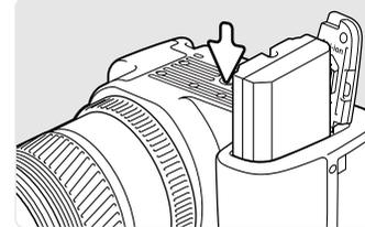
Legen Sie den Akku mit den Kontakten voran. Schieben Sie den Akku (an der Akkuverriegelung vorbei) soweit ein, bis die Akkuverriegelung einschnappt.
