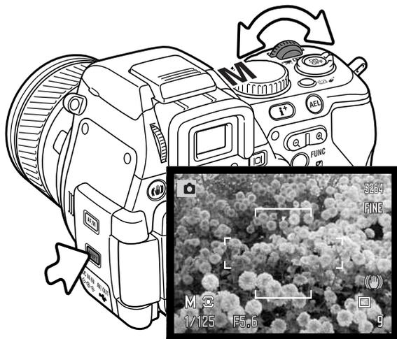
Drehen Sie das Einstellrad, um die Verschlusszeit einzustellen. Um die Blende einzustellen, halten Sie die Shift-Taste gedrückt und drehen Sie das Einstellrad. Die linke/rechte Steuertaste kann ebenfalls verwendet werden, um bei der vertikalen Aufnahme von Bildern die Blende zu verändern.
