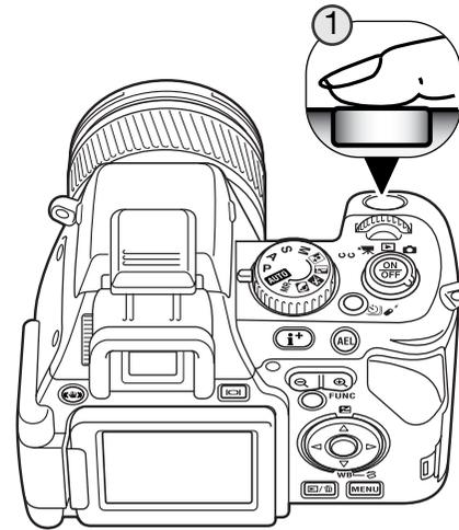
Bereiten Sie die Aufnahme, wie im Abschnitt „Aufnahme – Grundlagen“ beschrieben (S. 30), vor. Drücken Sie den Auslöser und halten Sie ihn gedrückt (1), um eine Serienaufnahme zu starten. Die Kamera nimmt solange Bilder auf, bis die maximal Anzahl von Bildern erreicht wurde oder der Auslöser wieder losgelassen wird.
