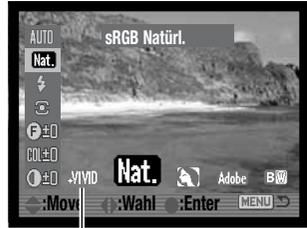
Im Farbmodus können Sie bestimmen, ob das Bild schwarzweiß oder in Farbe erzeugt werden soll. Des Weiteren können Sie den Farbraum festlegen. Die Einstellungen müssen vor der Aufnahme erfolgen. Der Farbmodus wird mit der Funktionstaste und der Steuertaste (S. 64) ausgewählt. Auf dem LCD-Monitor wird das aktuelle Bild im gewählten Farbmodus dargestellt. Der gewählte Farbmodus hat keinerlei Auswirkungen auf die Dateigröße des Bildes.
