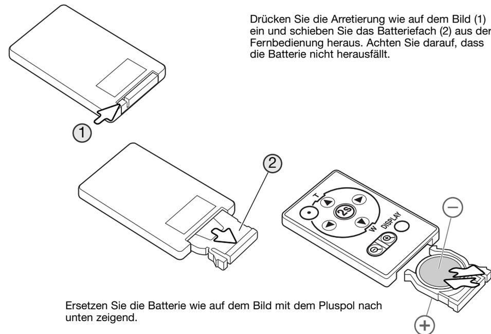
Drücken Sie die Arretierung wie auf dem Bild (1) ein und schieben Sie das Batteriefach (2) aus der Fernbedienung heraus. Achten Sie darauf, dass die Batterie nicht herausfällt.
