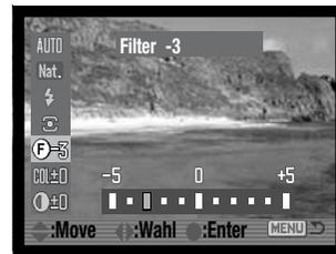
Der Gesamtfarbeindruck einer Szene kann hier verändert werden. Die Filtereffekte unterscheiden sich je nach gewähltem Farbmodus. Farbbeispiele finden Sie auf Seite 173. Die Filterkorrektur kann mit der Funktionstaste und der Steuertaste (S. 64) eingestellt werden. Beim Verändern des Filterwertes werden ein Symbol und eine Zahl angezeigt.
