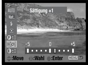
Die Sättigung kann vor der Aufnahme in elf Stufen ( $\pm 5$ ) angepasst werden. Farben können verstärkt (positiver Wert) oder abgeschwächt (negativer Wert) werden. Die Farbsättigungskorrektur kann mit der Funktionstaste und der Steuertaste eingestellt werden (S. 64).
