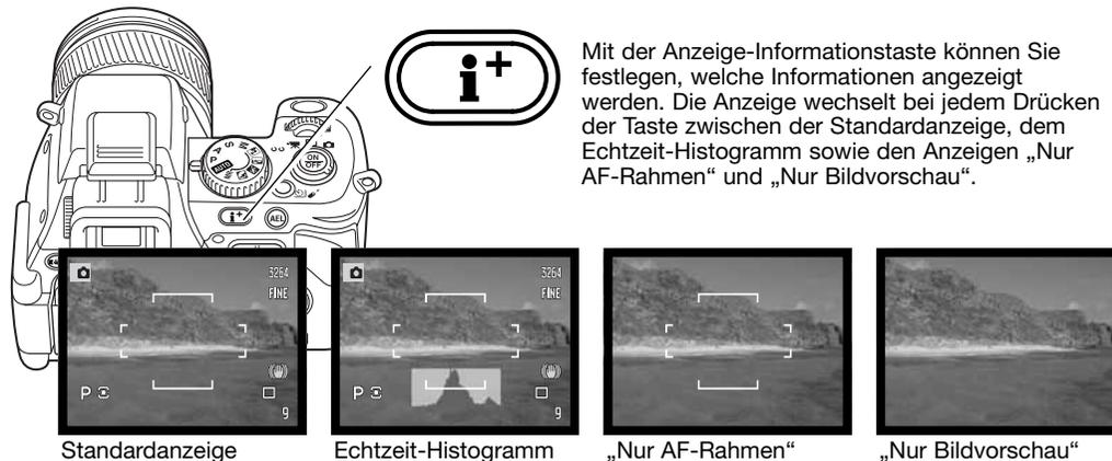
Mit der Anzeige-Informationstaste können Sie festlegen, welche Informationen angezeigt werden. Die Anzeige wechselt bei jedem Drücken der Taste zwischen der Standardanzeige, dem Echtzeit-Histogramm sowie den Anzeigen „Nur AF-Rahmen“ und „Nur Bildvorschau“.
