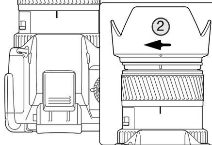
Setzen Sie die Vorderseite der Gegenlichtblende ganz auf das Objektiv auf und drehen Sie sie um 90° im Uhrzeigersinn bis sie einrastet und sich die runde Vertiefung in einer Linie mit dem Brennweitenindex (2) befindet. Ist die Blende richtig montiert, zeigen die großen Flügel nach oben und unten. Sie sollten die Gegenlichtblende nie mit Gewalt montieren. Wenn sie nicht passt, überprüfen Sie die Drehrichtung. Zum Entfernen drehen Sie die Gegenlichtblende einfach um 90° gegen den Uhrzeigersinn.
