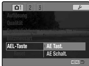
**AE Tast.** – Kameragrundeinstellung. Durch Drücken und gedrückt halten der AEL-Taste wird die Belichtungsmessung gespeichert. Die Belichtungsmessung bleibt gespeichert, solange die Spot/AEL-Taste gedrückt wird.
