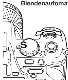
Die Blendenautomatik wird mit dem Belichtungsmodusrad eingestellt (S. 50). Der Fotograf wählt die gewünschte Verschlusszeit, und die Blendenautomatik stellt die passende Blende für die korrekte Belichtung ein. Wenn die Blendenautomatik aktiv ist, erscheint die Verschlusszeit im EVF-Sucher und auf dem LCD-Monitor blau.
