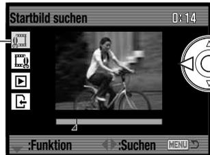
Verwenden Sie die linke/rechte Steuertaste, um das erste Bild (Startbild) von dem Abschnitt abzubilden, den Sie schneiden möchten. Der Positionsbalken und das Zählwerk in der rechten oberen Ecke des Monitors geben ungefähr an, an welcher Stelle Sie sich im Film befinden.
