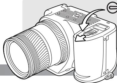
Schließen Sie die Akkuschachtklappe und schieben Sie die Akkuschachtverriegelung in die angezeigte Richtung.
