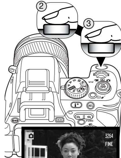
Drücken Sie den Auslöser leicht an (2), um die Scharf- und Belichtungseinstellung zu speichern.
