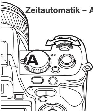
Die Zeitautomatik wird mit dem Belichtungsmodusrad eingestellt (S. 50). Der Fotograf wählt die gewünschte Blende, und die Zeitautomatik stellt die passende Verschlusszeit für die korrekte Belichtung ein. Wenn die Zeitautomatik aktiv ist, erscheint die Blendenzahl im EVF-Sucher und auf dem LCD-Monitor blau.
