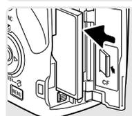
Schieben Sie die Speicherkarte ganz in das Kartenfach ein. Setzen Sie die Karte so ein, dass die Kartenvorderseite zum Kameraobjektiv zeigt. Achten Sie darauf, die Karte nicht zu verkanten. Wenden Sie niemals Gewalt an. Sollte die Karte blockieren, überprüfen Sie deren korrekte Ausrichtung.
