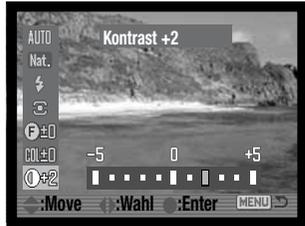
Der Kontrast kann vor der Aufnahme in elf Stufen ( $\pm 5$ ) angepasst werden. Der Kontrast kann verstärkt (positiver Wert) oder abgeschwächt (negativer Wert) werden. Die Kontrastkorrektur kann mit der Funktionstaste und der Steuertaste eingestellt werden (S. 64).
