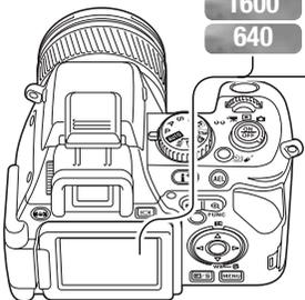
Die Auflösung bestimmt die Anzahl der Pixel. Je höher die Auflösung, um so größer wird die Bilddatei. Wählen Sie die Größe entsprechend der endgültigen Verwendung aus – eine kleine Auflösung ist passender für Internetseiten, eine hohe Auflösung ermöglicht eine höhere Qualität für Fotoabzüge. Die Auflösung 3264 X 2176 Pixel bewirkt ein Bildverhältnis von 3:2 anstatt normalerweise 4:3. Wenn Sie diese wählen, wird die Monitoranzeige oben und unten schwarz maskiert.
