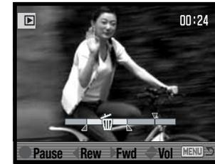
Drücken Sie die mittlere Steuertaste, um die Vorschau mit Schnitt zu erhalten. Der Pfeil über dem Positionsbalken zeigt die Position während der Wiedergabe an.
