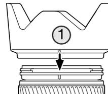
Die Gegenlichtblende verhindert das Eindringen von Streulicht in das Objektiv. Bei sehr heller Beleuchtung wird die Gegenlichtblende empfohlen. Die Gegenlichtblende sollte nicht in Verbindung mit dem eingebauten Blitzgerät benutzt werden, da es sonst zu Abschattungen kommen kann.
