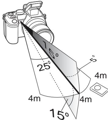
Die Fernbedienung sollte innerhalb des gezeigten Radius verwendet werden. Das Signal der Fernbedienung kann gestört werden, wenn das Zoomobjektiv ausgefahren ist oder Zubehör wie etwa die Gegenlichtblende oder ein Konverter verwendet werden. Rücklicht und fluoreszierende oder helle Belichtungen können die Fernbedienung ebenfalls stören.
