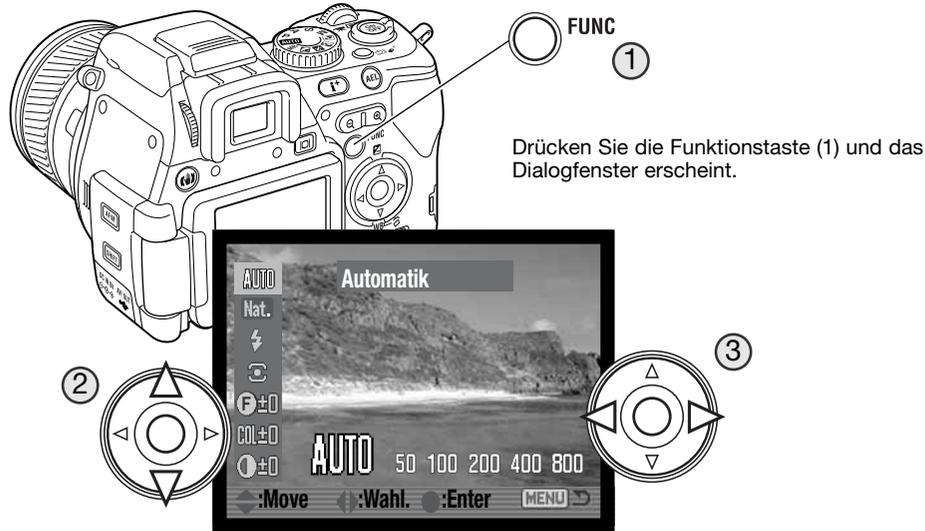
Verwenden Sie die untere/obere Steuertaste, um eine Funktion auszuwählen (2) und die linke/rechte Steuertaste, um die Einstellungen zu ändern (3). Drücken Sie die mittlere Steuertaste oder drücken Sie den Auslöser leicht an, um den Vorgang abzuschließen.
