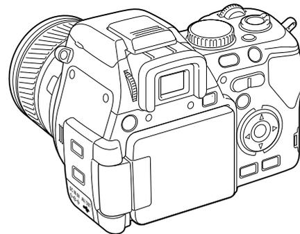
Wenn der LCD-Monitor mit dem Display zum Gehäuse hin eingeklappt wird, aktiviert sich der elektronische Sucher.
