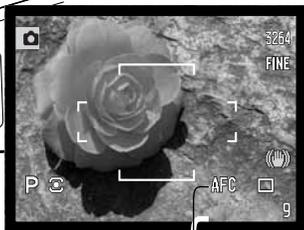
Statischer AF (Autofokus), Kontinuierlicher AF und manueller Fokus werden mit der AF-Funktionstaste eingestellt. Drücken Sie die Taste, um die gewünschte Funktion auszuwählen.
