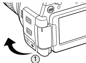
Öffnen Sie die Anschlussabdeckung (1). Die Abdeckung ist zum Schutz vor Verlust am Kameragehäuse befestigt.
