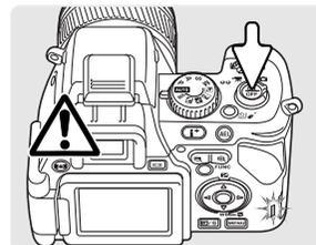
Wechseln Sie die Stromquelle niemals während des Betriebs der Kamera. Schalten Sie die Kamera grundsätzlich vorher ab. Versichern Sie sich, dass die Zugriffslampe nicht mehr leuchtet.
