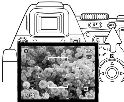
Die AEL-Taste speichert die Belichtungswerte des automatischen Belichtungssystems. Diese Funktion erlaubt es, die Belichtung mittels einer Graukarte oder eines Referenzmotivs außerhalb der Szene festzulegen. Bei Benutzung des Blitzgerätes unter Verwendung der Belichtungsfunktionen „P“ und „A“ ist die Langzeit-Blitzsynchronisation aktiviert (S. 71). Für die AEL-Taste können im Register 1 des Aufnahmemenüs (S. 92) benutzerdefinierte Einstellungen vorgenommen werden.
