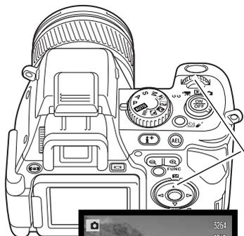
Bei den AF-Messfeld-Funktionen können Sie zwischen dem großen AF-Messfeld, einem einzelnen AF-Messfeld und dem flexiblen Fokuspunkt auswählen. Die Messfeld-Funktion kann nicht geändert werden, wenn Sie das Digitalzoom verwenden.
