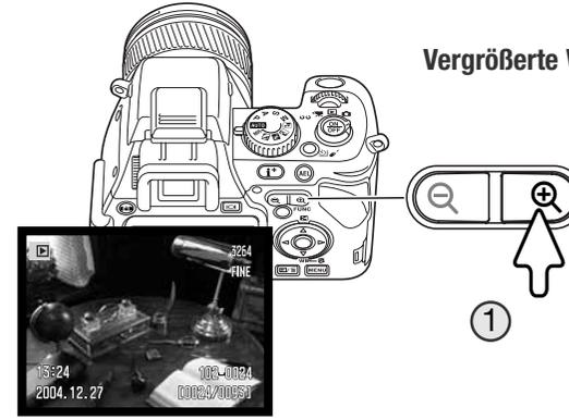
Bei der Einzelbild-Anzeige kann ein Bild zur näheren Betrachtung bis zu 10fach vergrößert dargestellt werden. Die Vergrößerung kann in Register 2 des Wiedergabemenüs (S. 120) als 2fach, 4fach oder 10fach voreingestellt werden. RAW-Bilddateien können nicht vergrößert dargestellt werden.
