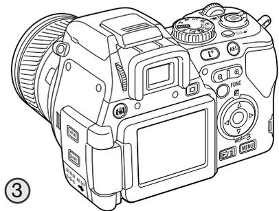
Wenn der LCD-Monitor nicht verwendet wird, sollten Sie ihn in seine Ausgangsposition stellen, damit die Oberfläche nicht beschädigt wird.
