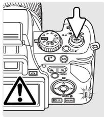
Um Bilder mit der Kamera aufnehmen zu können, muss eine Speicherkarte eingesetzt werden. Andernfalls erscheint eine „Keine Karte“-Warnmeldung auf dem LCD-Monitor. CompactFlash-Karten Typ I und II sowie Microdrives sind mit dieser Kamera kompatibel. Informationen über Pflege und Handhabung der Speicherkarte finden Sie auf Seite 166.
