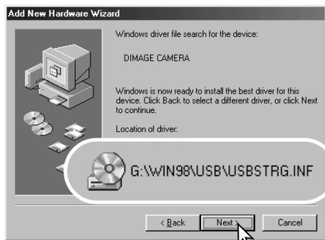
A opção wizard novo hardware confirmará a localização do driver. Click “Next” para instalar o driver no sistema. Um dos três drivers pode estar localizado em: MNLVENUM.inf, USBPDR.inf, ou USBSTRG.inf. A letra designando a drive CD-ROM varia de computador para computador.
