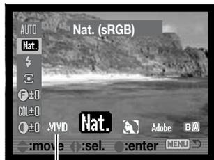
O modo de cor controla se a imagem é a cores ou a preto e branco. Deve ser fixa antes de gravar a imagem. O modo de cor é seleccionado com o botão de função e o controlador (p. 64). A imagem nos monitores reflecte o modo de cor seleccionado. O modo de cor não tem efeito no formato do ficheiro de imagem.
