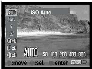
Pode seleccionar 5 configurações para a sensibilidade da câmara: Auto, 50, 100, 200, 400, and 800; os valores numéricos são baseados num ISO equivalente. ISO é o standard usado para indicar a sensibilidade da película:
