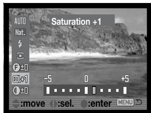
A saturação de cor de uma cena pode ser ajustada em onze níveis ( $\pm 5$ ). As cores podem ser acentuadas (valor positivo) ou esbatidas (valor negativo). A compensação de cor é fixa com o botão de função e o controlador (p .64).
