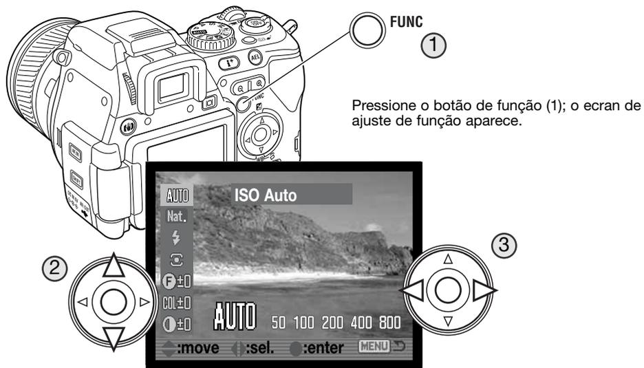
Use as teclas para cima/baixo do controlador para iluminar a função (2), e as teclas esq/dta para alterar o ajuste (3). Pressione o centro do controlador ou o disparador automático parcialmente para completar a operação.
