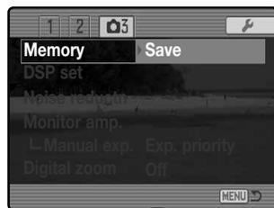
No ecrã de registo selecção, use as teclas esq/dta do controlador (1) para seleccionar o registo de memória no qual os ajustes vão ser gravados. Pressione o botão central do controlador (2) para gravar os ajustes; os ajustes anteriores serão apagados e substituídos pelos novos. O botão menu cancela a operação sem gravar os ajustes.
