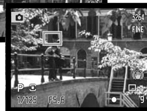
Pressionar o disparador do obturador até metade também completa a operação; a área AF pontual fica por breves instantes vermelha para confirmar a focagem.
