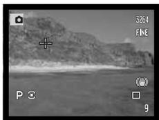
**Flex Focus Point** - um ponto de focagem em cruz que pode ser colocado em qualquer área da imagem (p. 48).
