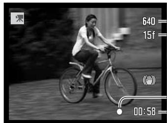
Coloque o assunto no centro da imagem real e pressione o disparador do obturador parcialmente para fixar a focagem. Use o sinal de focagem para confirmar o foco.
