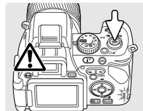
Desligue a câmara e confirme que a lâmpada de acesso não está acesa antes de substituir a fonte de alimentação.
