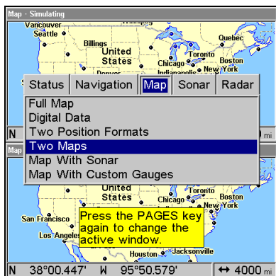
Menu des Affichages, avec l'option "Deux Cartes" sélectionnée (à gauche). Les deux fenêtres sont ici en position horizontale. Ecran Cartographique avec deux fenêtres verticales (à droite).
