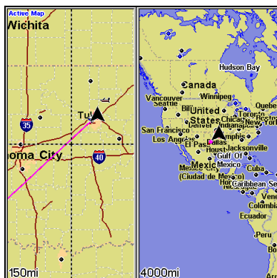
Menu des Affichages, avec l'option "Deux Cartes" sélectionnée (à gauche). Les deux fenêtres sont ici en position horizontale. Ecran Cartographique avec deux fenêtres verticales (à droite).
