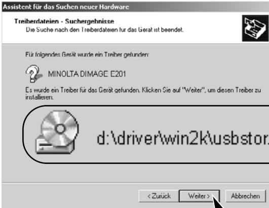
Der Name des Treibers wird in einem Bestätigungsdialog angezeigt. Klicken Sie auf „Weiter“, um den Treiber zu installieren.
