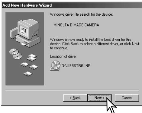
A janela “add new hardware” pode ser usada para indicar a localização do driver. Quando a localização é mostrada na janela click “Next. para instalar o driver no sistema. ”
