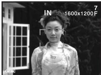
Coloque o assunto dentro da guia de focagem ou centre o assunto no visor. Pressione e mantenha o botão disparador do obturador parcialmente, para fixar a focagem. A lâmpada indicadora acende firme e área de focagem fica vermelha quando a focagem está bloqueada.
