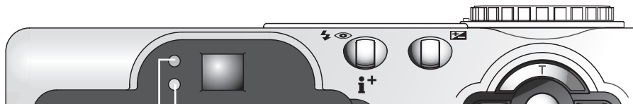
Témoin de mise au point (vert) — Témoin de flash (orange)
