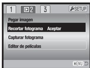
Visualice la imagen a recortar en el monitor LCD. Seleccione la opción de recortar fotograma en la sección 2 del menú de Reproducción, y presione el botón central para empezar el proceso de recorte.
