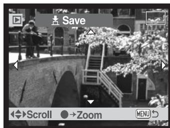
Repita las operaciones de zoom y desplazamiento para ver la zona de la imagen a recortar. El tamaño de imagen mínimo que se puede recortar es de 320 X 240.
