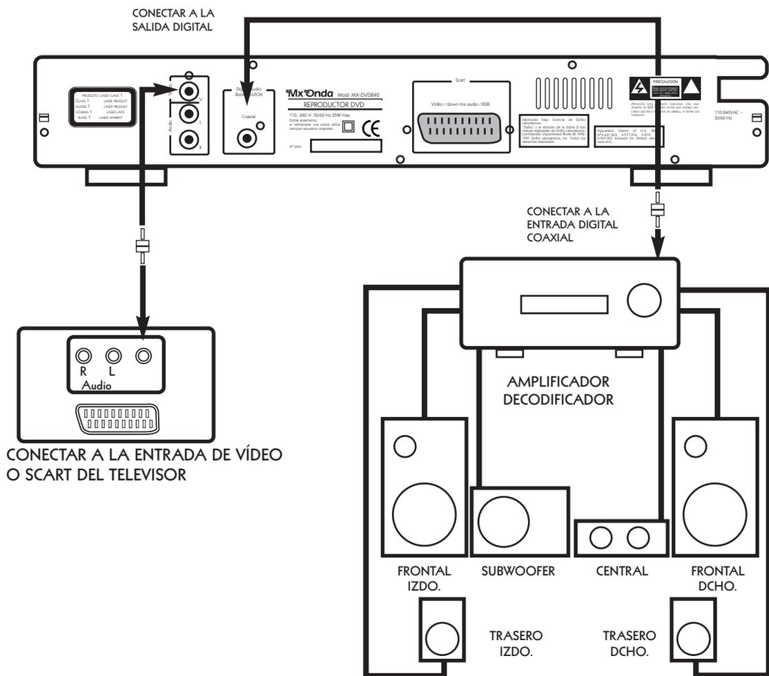
Conecte la salida digital de audio procedente del reproductor a la entrada digital (coaxial) de un amplificador receptor 5.1 DOLBY DIGITAL o DTS.
