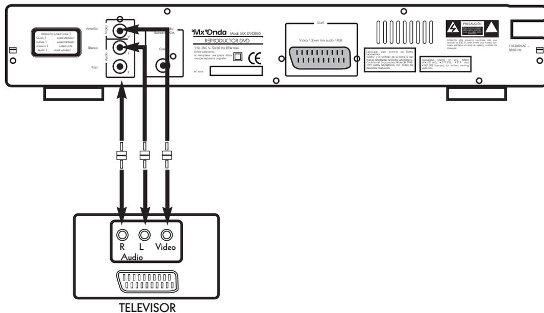
Conecte la salida de vídeo compuesto (Vídeo) y la salida de audio estéreo (Audio) canal izquierdo (L) y canal derecho (R) del reproductor, a las entradas correspondientes de vídeo y audio (canal izquierdo y canal derecho) del televisor.
