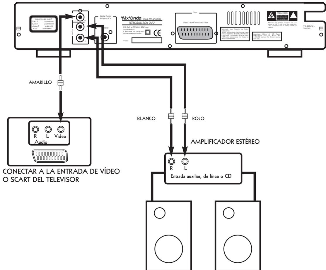
Conecte la salida de audio estéreo (Audio) canal izquierdo (L) y canal derecho (R) del reproductor, a la entrada (auxiliar, línea o CD) del amplificador.
