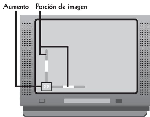
2. Una vez aumentado el tamaño de la imagen utilice los botones del cursor para recorrer la misma. En la pantalla del televisor aparecerá la indicación de la porción de imagen que se está visualizando.
