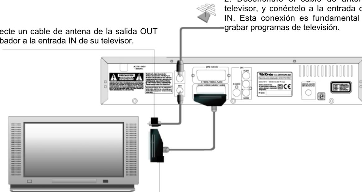
4. Conecte el cable SCART en la salida EXT1 To TV-I/O y en el conector SCART de su TV.
