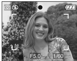
Cuando las áreas múltiples AF (máx. 9 áreas) iluminan al mismo tiempo, la cámara enfoca hacia todas las áreas AF. La posición de enfocado no es predeterminada porque está ajustada en la posición que determina automáticamente la cámara al momento del enfoque. Si usted desea determinar la posición de enfoque para tomar imágenes, cambiar el modo AF a modo Enfocado –área-1 ó modo Enfocado-área-específica.
