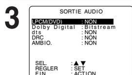
Appuyer sur ▲▼ pour sélectionner une rubrique. Appuyer sur SET à répétition pour modifier le paramétrage. (voir ci-dessous)
