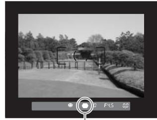
Témoin de mise au point
