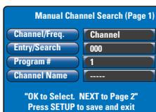
{ **Channel/Freq.** } (Can./Freq.) – Selezionare la ricerca manuale in base all'allocazione dei canali o alla frequenza: Programme, **FREQ.** S. Channel, **Nota:** S. Channel (Canale speciale) si riferisce ai canali iperbanda specificati.
