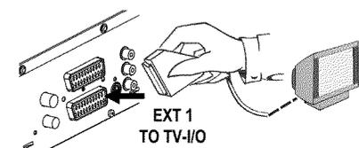
❹ A l'aide d'un câble péritel spécial (compatible avec Easylink), raccordez la prise péritel **EXT 1 TO TV-I/O** située au dos de l'enregistreur de DVD à la prise péritel - compatible avec le système Easylink - du téléviseur (consultez le mode d'emploi du téléviseur).
