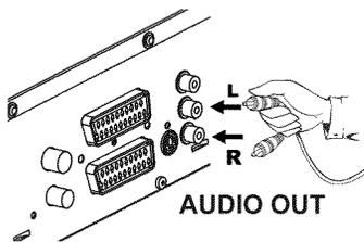
Vous trouverez au dos de l'enregistreur de DVD deux sorties audio analogiques **OUT L AUDIO R** (Signal de sortie audio gauche / droite)
