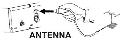
❸ Avec le câble d'antenne fourni, raccordez la prise **TV OUT** située au dos de l'enregistreur de DVD à la prise d'entrée de l'antenne sur le téléviseur.
