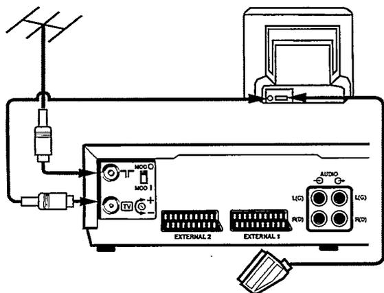
Saque la clavija del cable de antena del televisor e insértela en el conector 'T' en la parte posterior del vídeo.
