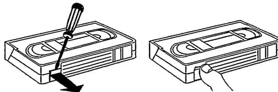
Si se pretende grabar de nuevo la casete, ha de cerrarse la abertura con una cinta adhesiva. Sustituir la cinta adhesiva que se ha desprendido parcialmente.
