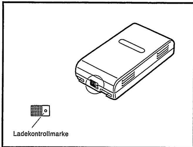
Diese Marke ermöglicht eine bequeme Unterscheidung zwischen einem aufgeladenen und einem entladenen Akku. Wenn der Punkt sichtbar ist, bedeutet dies, daß der Akku aufgeladen ist; bei einem entladenen Akku dagegen ist der Punkt nicht sichtbar.
