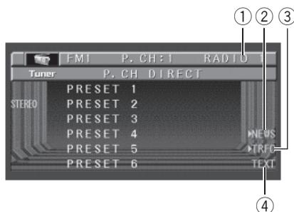
La funzione RDS (radio data system) serve per trasmettere delle informazioni durante le trasmissioni in FM. Queste informazioni impercettibili forniscono elementi come il nome di servizio del programma, il tipo di programma, l'attesa di notiziari sul traffico e la sintonizzazione automatica, con lo scopo di aiutare gli ascoltatori della radio nella ricerca e nella sintonizzazione della stazione desiderata.
