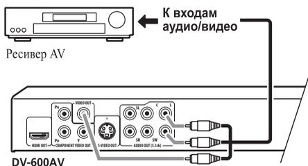
**2 Подключите видеовыход A/V ресивера к видеовыходу телевизора.**
