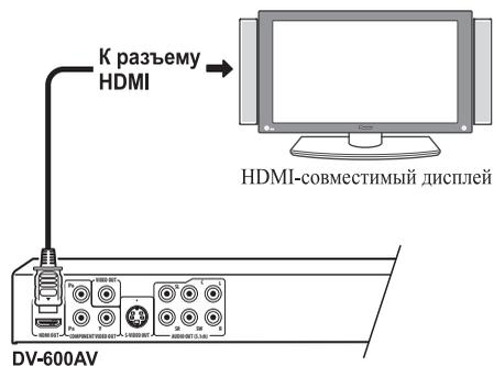
Для обеспечения надлежащего соединения с разъемом на проигрывателе стрелка на разъеме кабеля должна находиться сверху.
