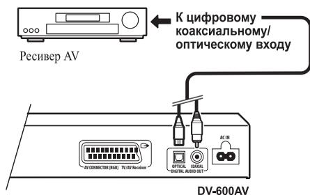
*только DV-600AV:* При оптическом подключении используйте оптический кабель (не входит в комплект поставки) для подключения разъема **OPTICAL DIGITAL AUDIO OUT** к оптическому входу A/V ресивера.
