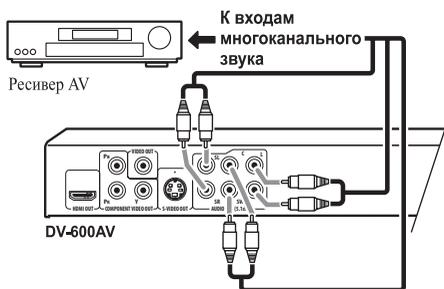
Для подключения к ресиверу AV также при желании можно использовать разъем SCART AV, S-video (только DV-600AV) или разъемы компонентного видео.
