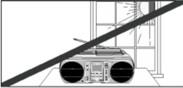
Избегайте воздействия на магнитофу прямого солнечного света и других источников тепла. Это может привести к перегреву магнитофы и нарушению ее нормальной работы.
