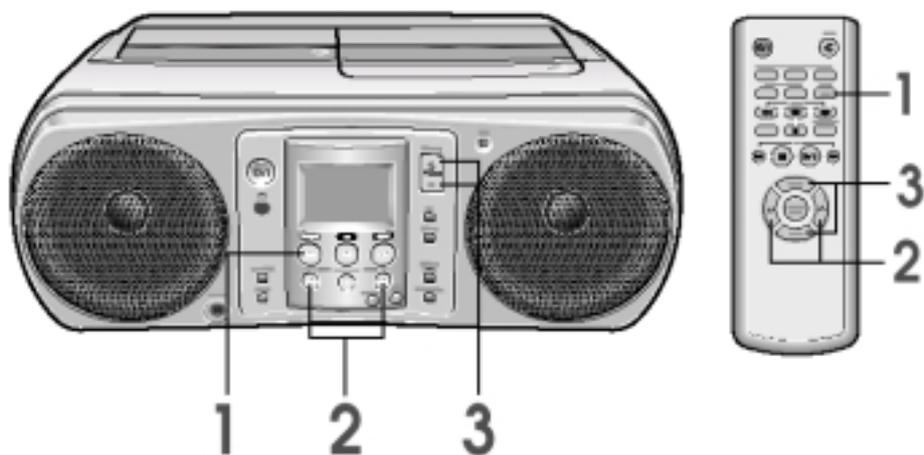
**1** Выберите желаемый диапазон частот нажатием кнопки TUNER/BAND (Тюнер/Диапазон).
