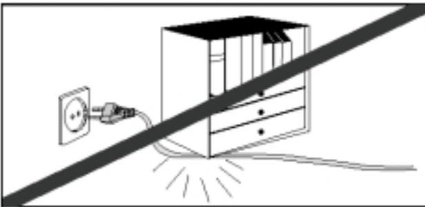
Не ставьте на сетевой шнур тяжелые предметы. Повреждение сетевого шнура может привести к выходу магнитофы из строя (опасность возникновения пожара) или к поражению электрическим током.
