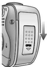
1. Abra a tampa do compartimento das baterias pressionando-a na direção da seta.
