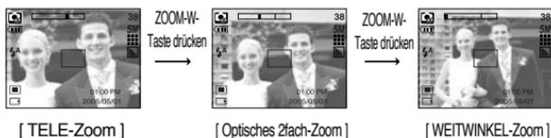
**Digitales WEITWINKEL-Zoom** : Ist der Digitalzoom in Betrieb, wird durch Drücken der Zoomtaste W der digitale Zoom schrittweise verringert.
