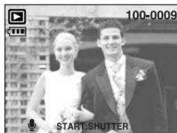
3. Premere il pulsante dell'otturatore per avviare la registrazione; la voce verrà registrata sull'immagine fissa per 10 secondi. Durante la registrazione della voce, la finestra di stato corrispondente verrà visualizzata nel modo illustrato in figura.
