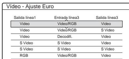
**5** Pulse **↑/↓** para seleccionar **“Video”** o **“RGB”** para **“Salida línea1”**, **“Decodifi.”** para **“Entrada línea3”** y **“Video”** para **“Salida línea3”** y, a continuación, pulse **ENTER**.
