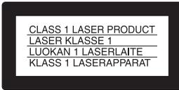
Dieses Gerät wurde als Laser-Gerät der Klasse 1 (LASER KLASSE 1) klassifiziert. Das entsprechende Etikett (LASER KLASSE 1) befindet sich außen an der Rückseite des Geräts.
