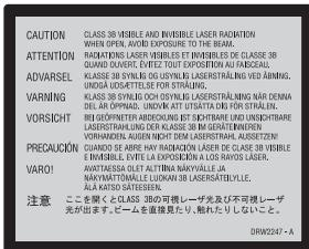
Cette étiquette est apposée sur le boîtier protecteur du laser à l'intérieur du boîtier de l'appareil.
