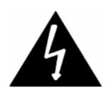
El símbolo de un relámpago con el extremo terminado en una flecha, en el interior de un triángulo equilátero, alerta al usuario de la presencia de "voltajes peligrosos" no aislados en el interior del producto que podrían tener potencial suficiente para provocar descargas eléctricas y peligro de muerte.
